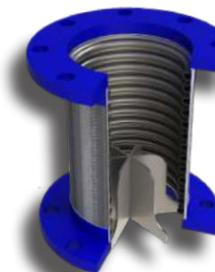
**CONECTOR PARA BOMBAS VANE FLEX™:** El conector para bombas Vane Flex™ ofrece la misma capacidad de estabilización de flujo que un tramo de **tubería equivalente de 10"** instalado en la descarga de la bomba. Al mismo tiempo, ofrece un alivio de los esfuerzos y amortigua las vibraciones del conector de una bomba en un espacio muy pequeño.
